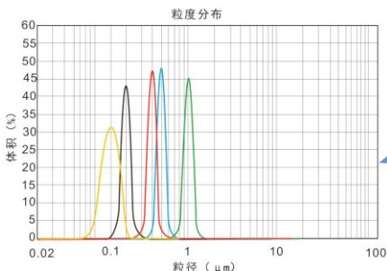
100nm, 200nm, 400nm, 500nm, 1μm NIST标样结果，准确度均优于0.6%（左图）。数十次玻璃珠实际样品测量，D3, D10, D50, D90, D97重复性误差均小于0.5%（右图）。
