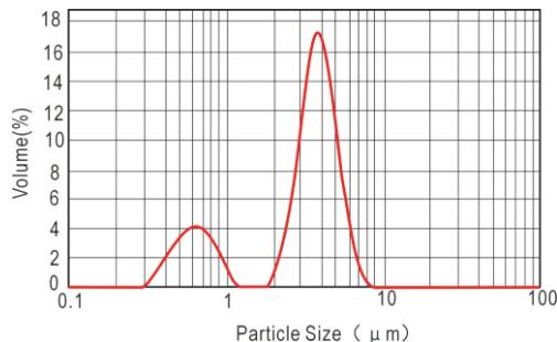
ACAD现象对激光粒度仪的工作造成了干扰。典型的案例例如 $3\mu\text{m}$ 聚苯乙烯微球的测量，如果不做软件方面的“特殊处理”，就会出现如左图所示的混乱结果。
