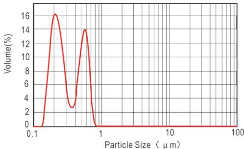
一般仪器空气中的最大接收角只有70度左右，对应水中为44.95度。这意味着在介质中看，44.95度以上的散射光（称为“超大角散射光”）不能被探测，从而产生原理性的测量盲区。超大角散射光的缺失，会对某些亚微米颗粒的测量造成困扰。左图是超大角散射光缺失情况下 $0.4\mu\text{m}$ 颗粒的测量结果。
